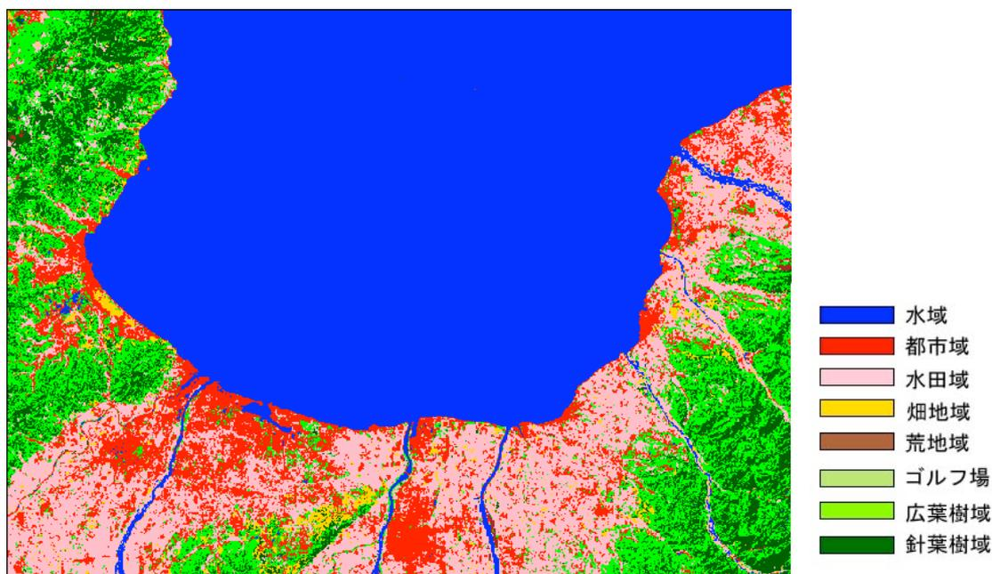
図 4.2.6-1 LANDSAT 衛星データ (撮影日: 1972/10/5) による教師付き土地被覆分類結果
